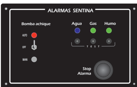
2- Bomba de achique activada La alarma es real, Se activa la bomba
